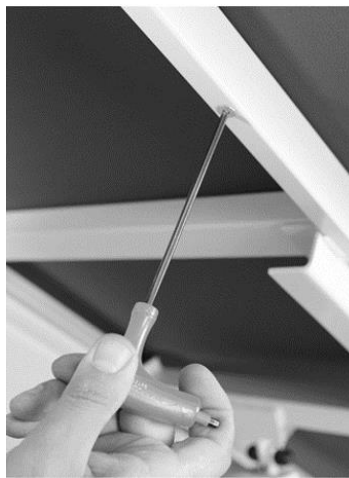
Abbildung 2: Abschrauben der Liegefläche
