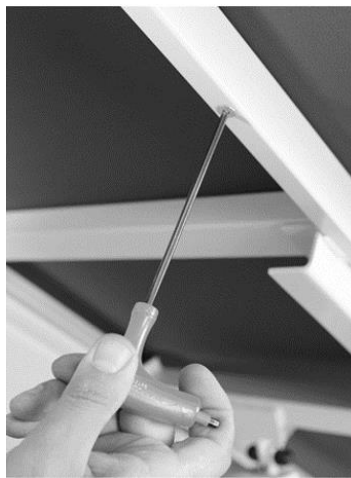
Abbildung 2: Abschrauben der Liegefläche
