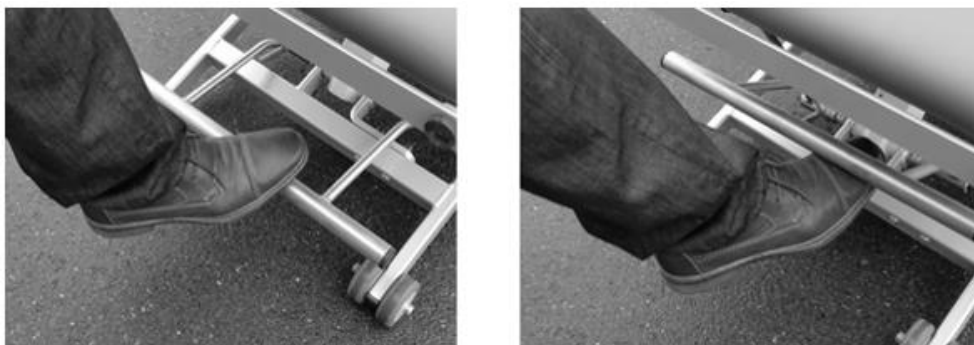
Abbildung 5: Bedienung der Hydraulikpumpe
