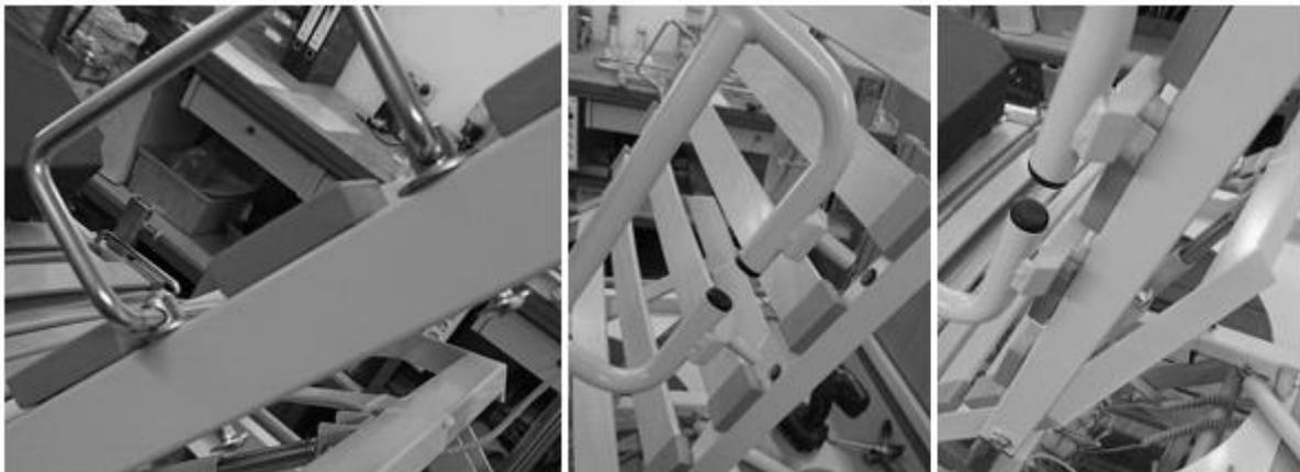
Abbildung 13: Reihenfolge für die Montage des Zugriffs anstelle des Matratzenhaltebügels
