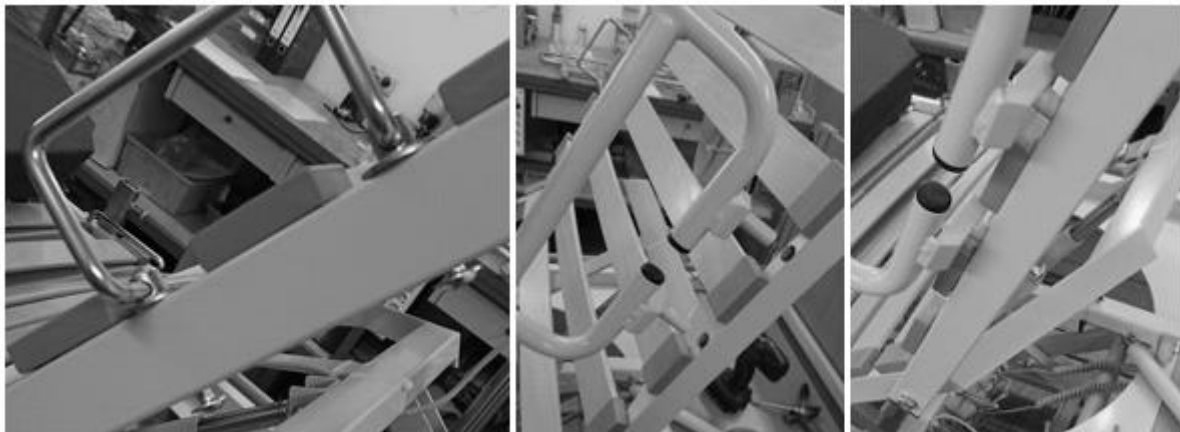
Abbildung 7: Reihenfolge für die Montage des Zugriffs anstelle des Matratzenhaltebügels
