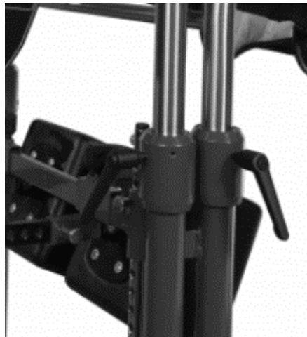
Abbildung 3: Klemmhebel zur Tischhöhenverstellung
