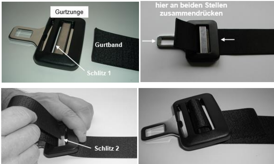
Abbildung 2: Vorgehen beim Einschlaufen des Gurtbands
