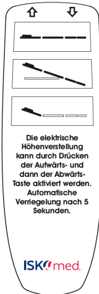
Abbildung 6: 3-reihiger Handschalter (1. Tastenreihe: Höhenverstellung, 2. Tastenreihe: Stehfunktion, 3. Tastenreihe: Kopfteilverstellung)
