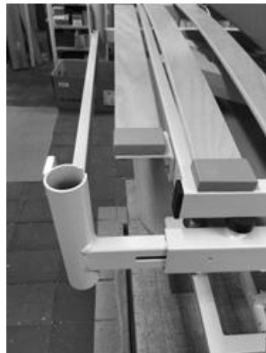
*Abbildung 13: Montage der Kopftraverse (220 cm Liegeflächenlänge)*
