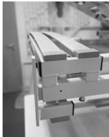
Abbildung 10: Montage der Fußtraverse (200 cm Liegeflächenlänge)
