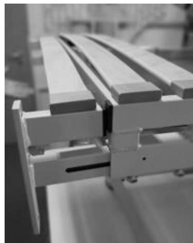
Abbildung 11: Montage der Fußtraverse (210 cm Liegeflächenlänge)
