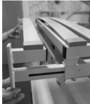
*Abbildung 12: Montage der Fußtraverse (220 cm Liegeflächenlänge)*
