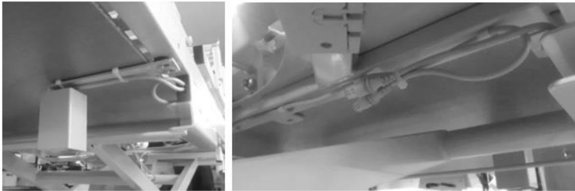
Abbildung 16: Montageart der Endschalter beim Einbaurahmen oder 14 cm dicker Matratze
