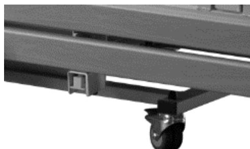
*Abbildung 9: Gedrückter Taster/Endschalter durch herabgelassenen Seitenholm*
