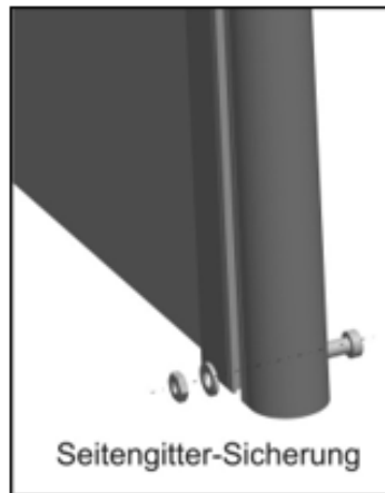
Abbildung 4: Seitengitter-Sicherung – als unterer Anschlag der Holzseitenholme
