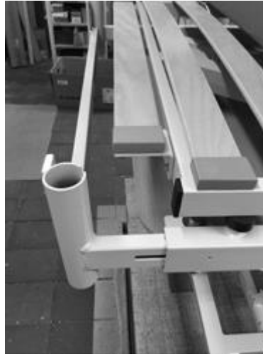
Abbildung 8: Montage der Kopftraverse (220 cm Liegeflächenlänge)
