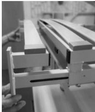
Abbildung 7: Montage der Fußtraverse (220 cm Liegeflächenlänge)
