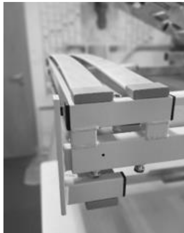
Abbildung 5: Montage der Fußtraverse (200 cm Liegeflächenlänge)
