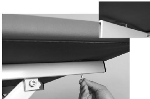
Abbildung 4: Festschrauben der Liegefläche
